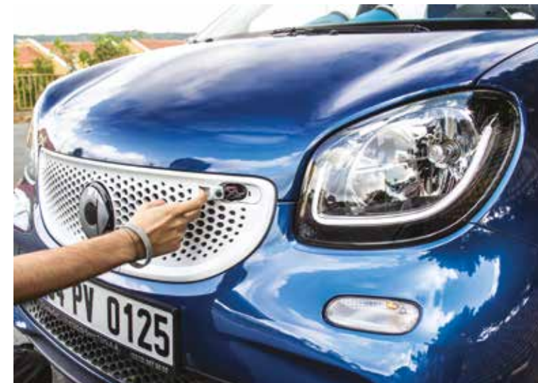
İzgaradaki iki kol çekilince çok hafif olan kaput açılıyor fakat motor burada değil
